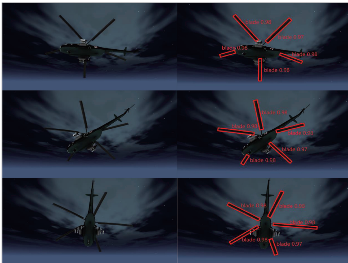
图 13 FMSA-RD 方法在自制室外仿真桨叶夜晚验证集上的检测结果
