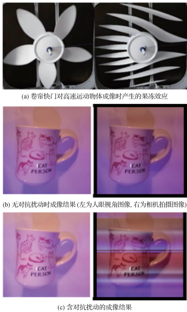
图 15 针对卷帘快门技术设计基于光影投射的对抗攻击结果示意(Sayles等,2021)
