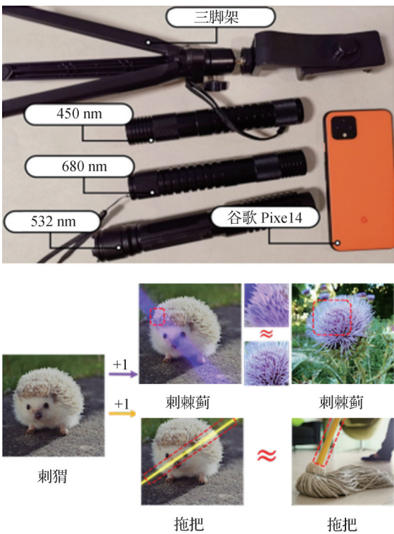
图 16 基于激光的无接触对抗攻击实验器件以及实验结果 (Duan 等,2021)
