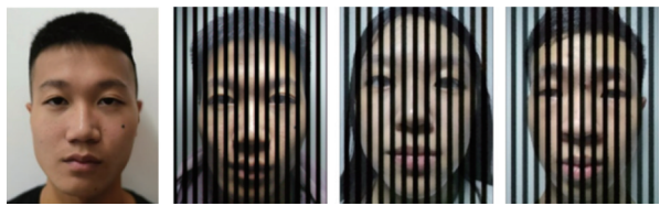
图 24 通过编码 LED 灯开关频次实现人脸成像表面叠加黑白条纹(Fang 等, 2024)
