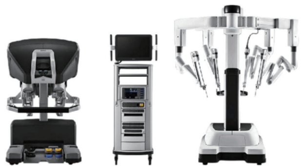
主端医生操作台 三维腹腔镜及摄像系统 从端病人操作台 图1 腔镜手术机器人系统
