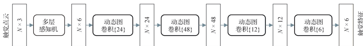
图2 触觉特征提取模块（一次触觉）
