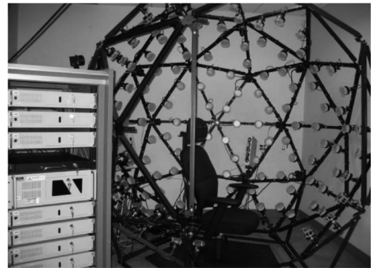
图 6 包含 16 台数码相机和 150 个 LED 灯的人脸扫描球 (Weyrich 等,2006)
