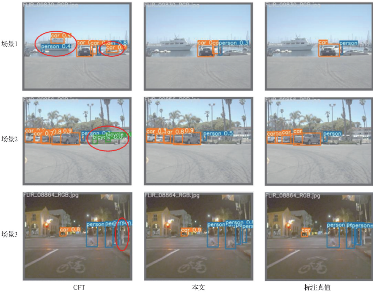
图8 FLIR数据集上的目标检测可视化结果对比 Fig. 8 Visual comparison of object detection on the FLIR dataset
