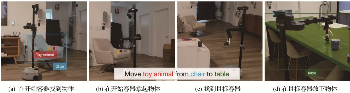
图3 具有移动能力的机器人完成组合技能任务
