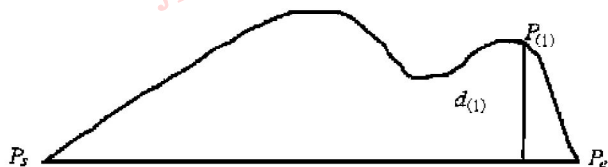
图 3 通过最大曲率来分割曲线
