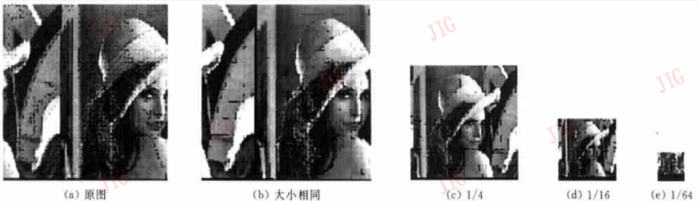
图 6 Internet 图象分级压缩编码、传输的不同大小重构图象
