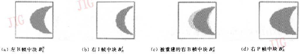
图2 当参考帧组合中某块的内容出现局部形变时,基于固定块方法得到的重建块示意图 图中字母 B 表示图象块(block), (下标 L 表示左; R 表示右; I, B, P 分别代表 I 帧, B 帧, P 帧)
