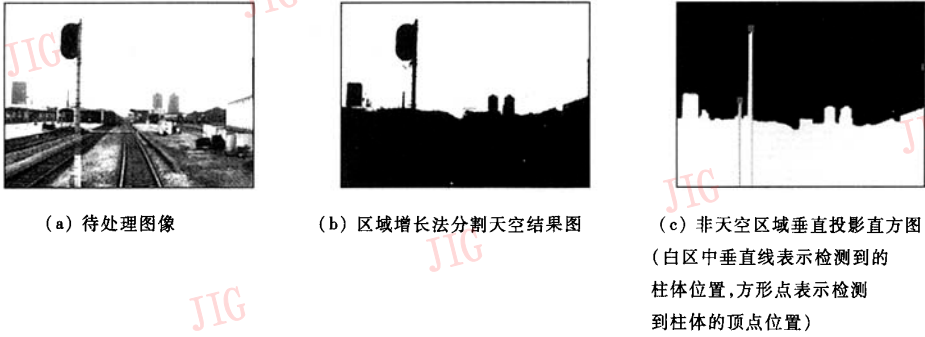
图 3 柱体顶点位置检测原理
