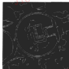
(g) 图 4(f) 的链码重构的轮廓
