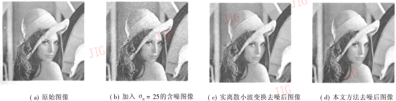
图 4 本文方法与实离散小波变换含噪 Lena 图像去噪效果对比
