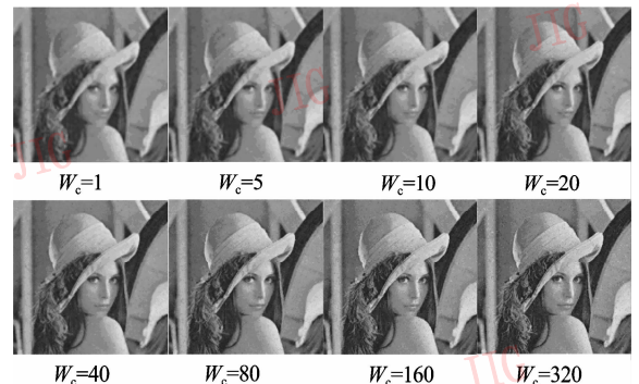
图 4 CWMy 输出图像随 W_c 变化结果
