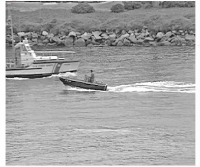
(c) QP 值为 25, coastguard 序列 第 33 帧 AVS-M 解码图 (编码比特数为 88 056 bits)
