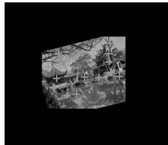
(c) SIFT描述器的匹配结果(邻接比取0.52,获得16个点对,匹配正确率为75%)
