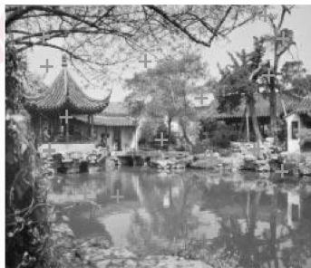
(c) SIFT描述器的匹配结果(邻接比取0.52,获得16个点对,匹配正确率为75%)
