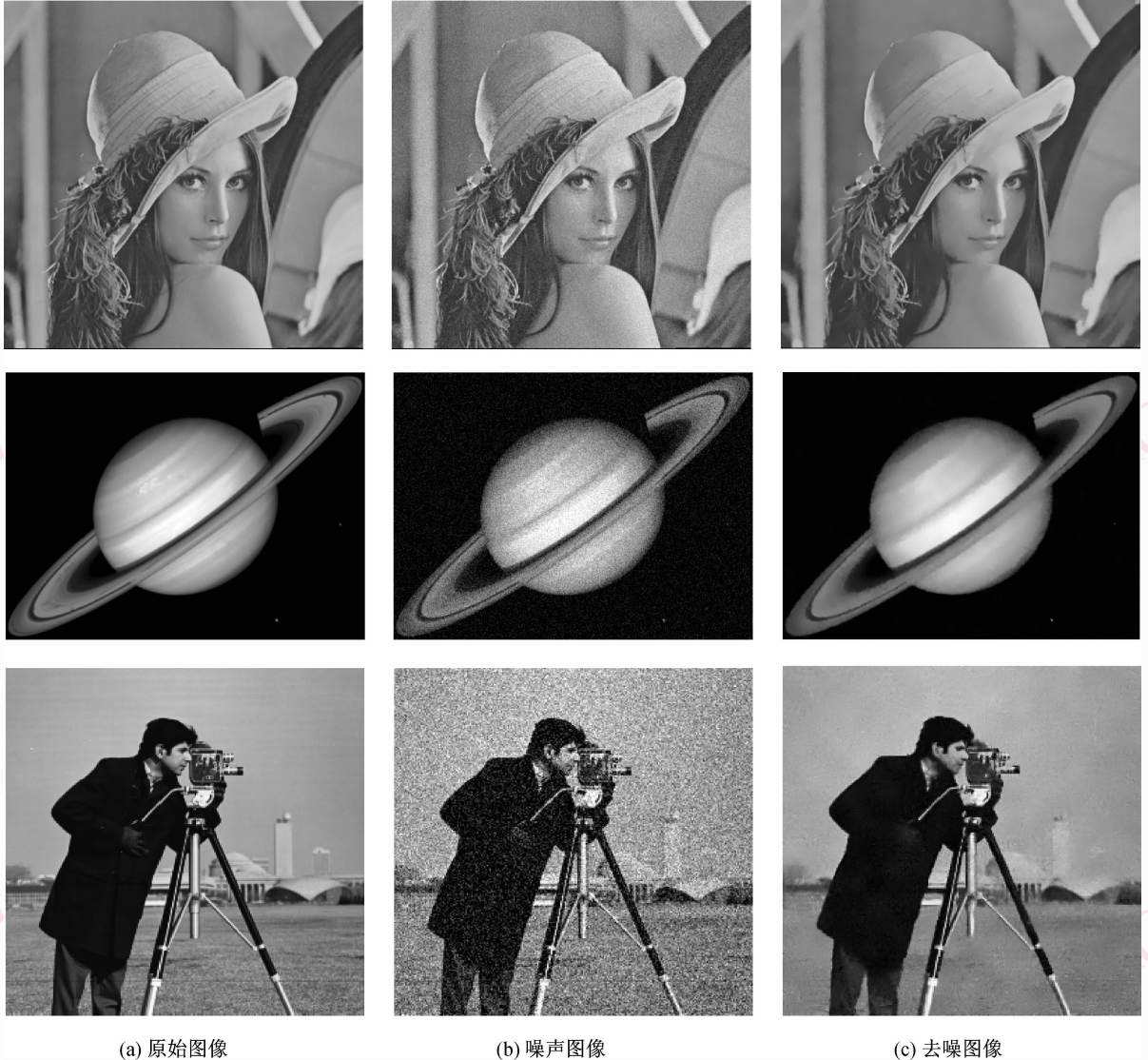
图 2 ANL-Means 算法在不同图像和不同噪声水平下的去噪效果
