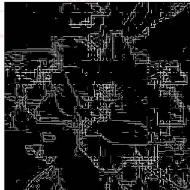
图 5 用 Prewitt 算子对图 2 进行的边缘检测
