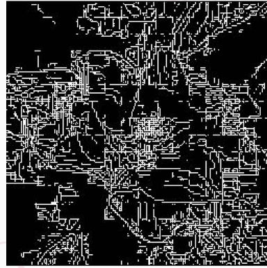
图 7 用 Prewitt 算子对图 4 进行的边缘检测
