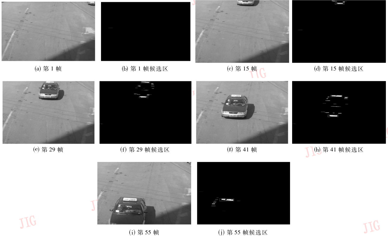
图 9 监控录像车牌定位实验结果
