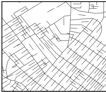
图3 道路网中多边形的主方向计算结果 Fig. 3 An example of main directions of polygons
