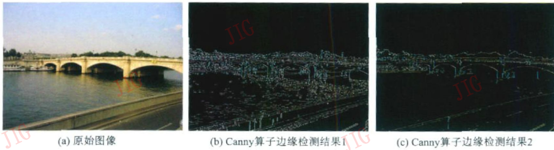
图 1 对同一图像用不同参数进行 Canny 边缘检测 [14] 的结果
