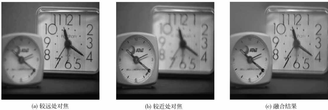
图 9 不同距离对焦成像照片的融合 Fig.9 Fusion of images with different focus
