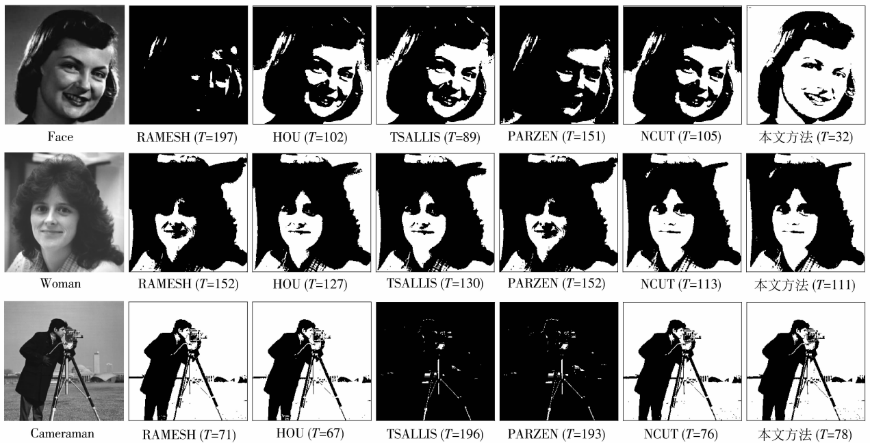
图 3 经典灰度图像的阈值分割结果及阈值
