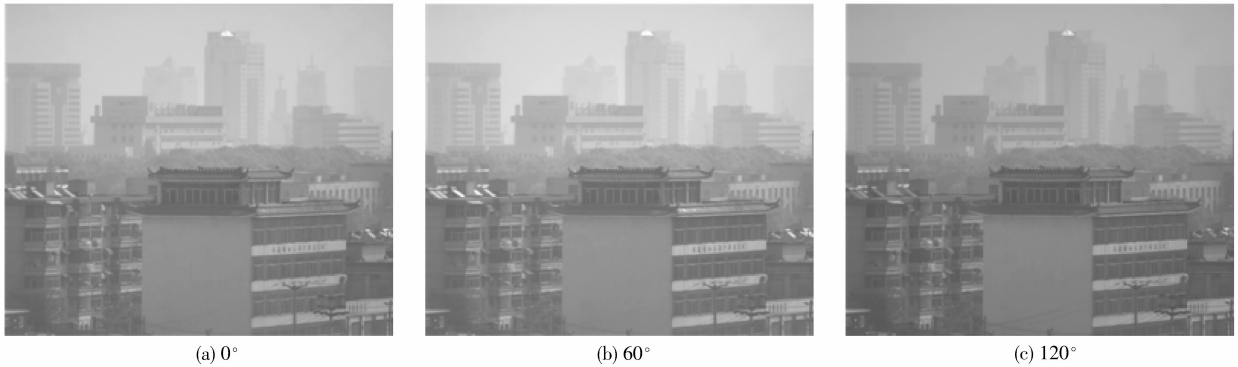
图 1 雾天条件下的 3 幅不同偏振方向图像 Fig. 1 Three images of different polarization orientation under foggy conditions
