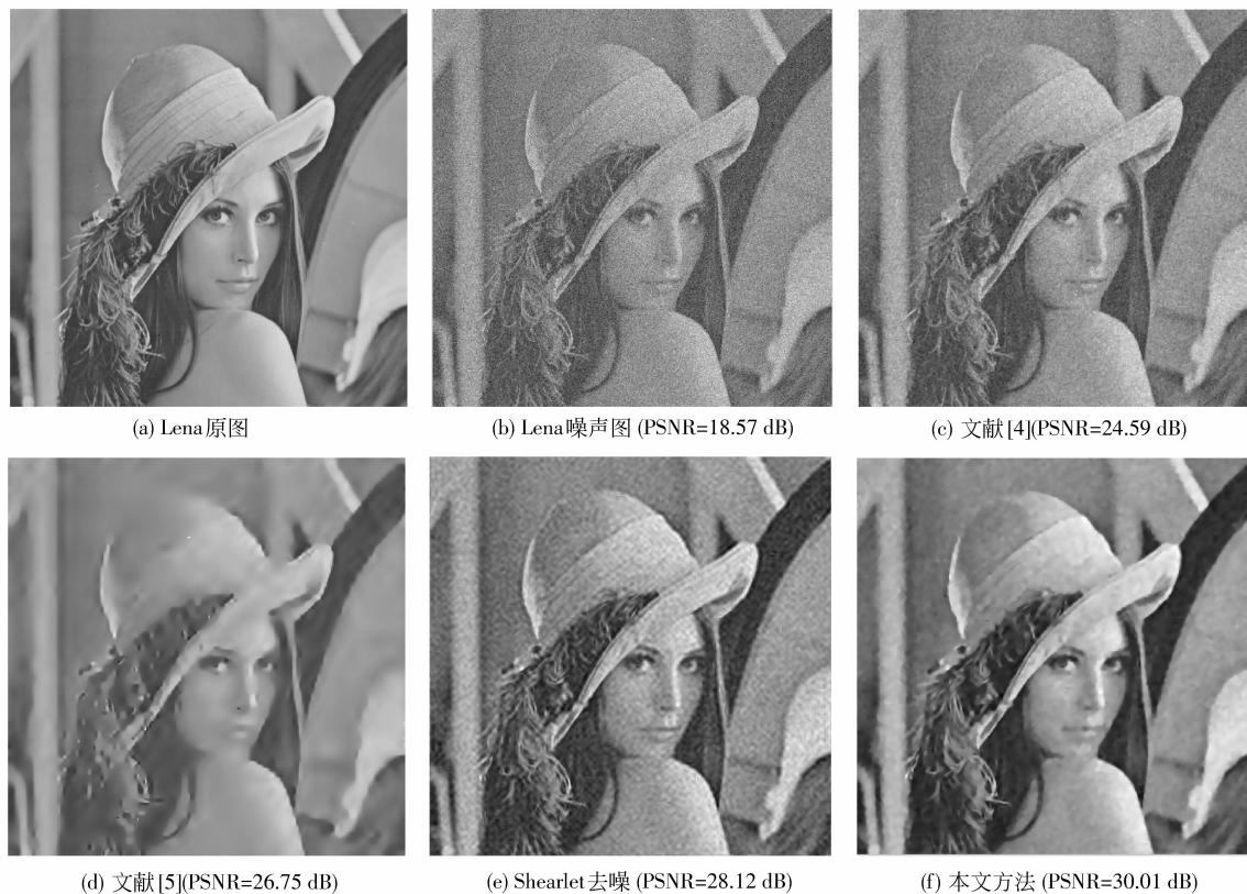
图 4 噪声标准差为 30 时,各算法重建的 Lena 图像 Fig. 4 Reconstructed Lena image of various methods at s = 30
