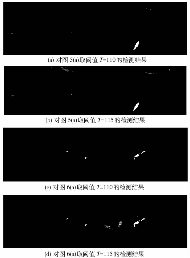
图 7 基于灰度阈值的杂质检测结果
