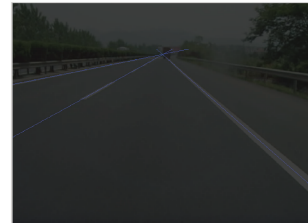
图 19 本文算法在低照度下的 AOI 提取
