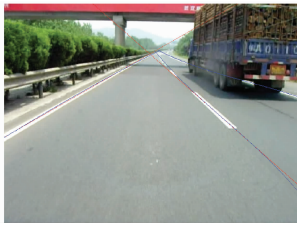
图 16 超车、大面积遮挡、阴影、较强日光干扰下弯道提取 (红色线 RF、HT 提取; 蓝色线本文算法提取)
