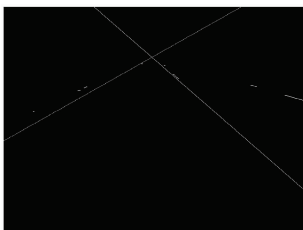
图 10 对细化后距离较远的两个最大连通区域进行直线拟合
