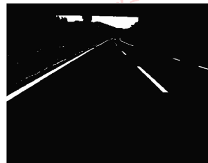
图 4 二值图像阈值为 245 Fig.4 Binary image threshold:245
