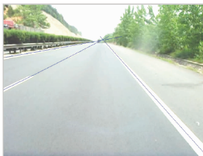
图 18 本文算法在强日光照射下 AOI 提取
