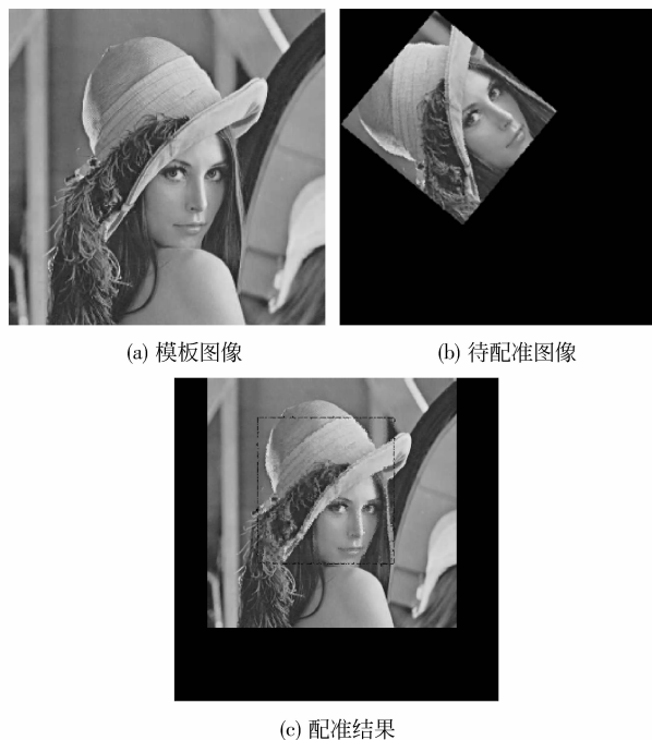
图 2 具有旋转、缩放和平移变换的图像配准
