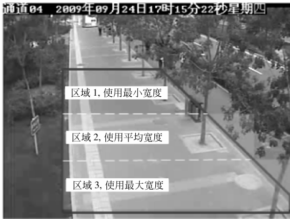
图 3 本文中使用的透视模型示意图
