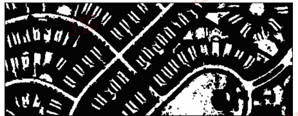
图 3 经分割后去除面积 T_s \leq 30 像素后的结果图 Fig. 3 Result of segmentation T_s \leq 30
