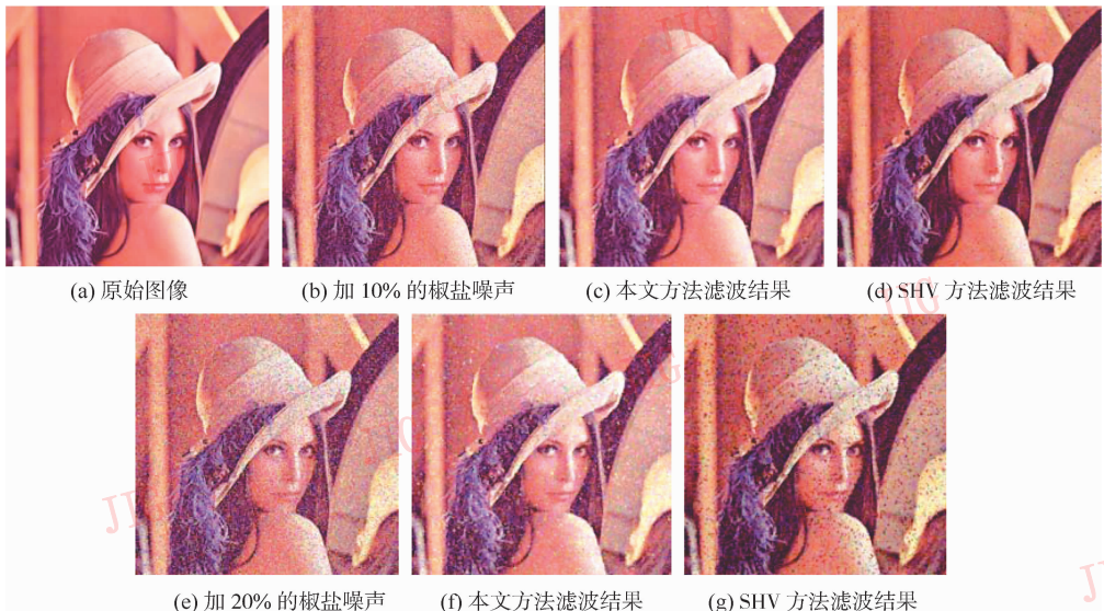
图 4 本文方法和 HSV 方法在不同噪声情况下的滤波对比
