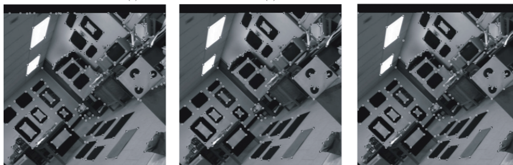
(c) 根据角点局部自适应阈值去除圆形角点 (d) 根据角度阈值去除虚假角点 (e) 曲线端点和T交叉点的检测
