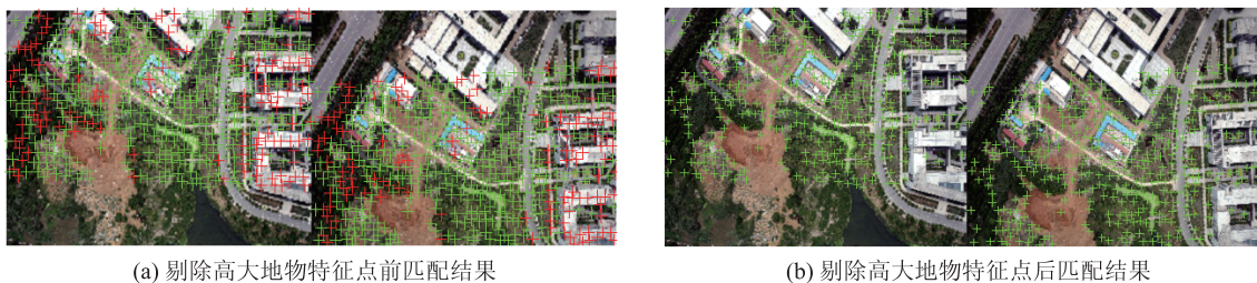
图7 第3组数据中1对无人机影像高大地物特征点剔除前后的匹配结果
