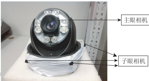
(b) 本文全景式仿生复眼视觉探测跟踪系统实物装置
