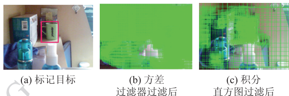
图3 Sliding-window 块集合通过过滤器
