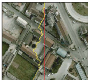
邻域最短距离法寻找最佳拼接缝(第227页)
