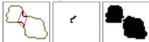
(a) 确定粘连区域 (b) 提取分割线 (c) 分割结果
