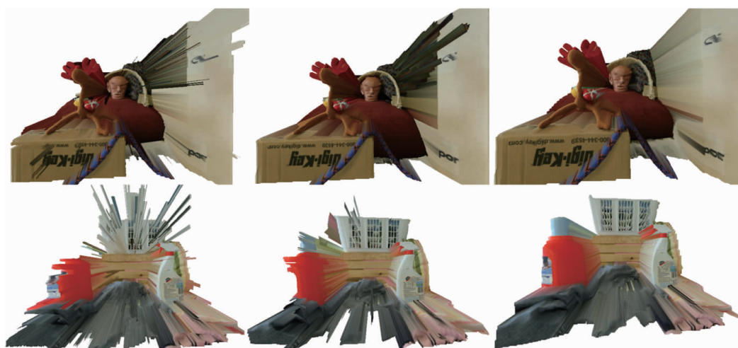
(a) 局部立体匹配结果 [10] 渲染图像 (b) 全局立体匹配结果 [12] 渲染图像 (c) 本文算法的渲染结果
