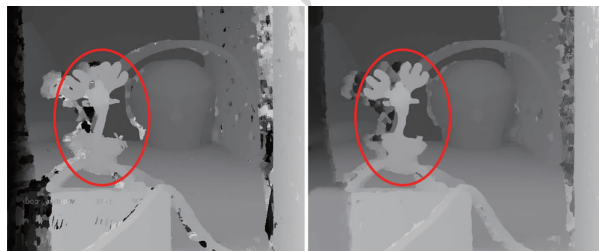
(a) 引导图像权值 [10] 的匹配结果 (b) 本文自适应权值的匹配结果
