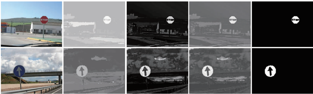
(a) 原图 (b) 自下而上的显著图 (c) 自上而下的显著图 (d) 最终的显著图 (e) 显著物体分割
