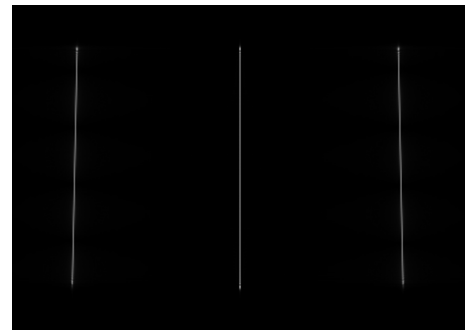
(a) PFA 未作方位插值直接方位压缩的曲线
