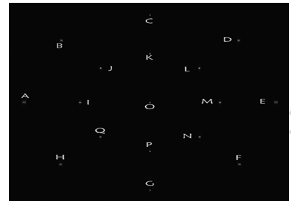
(c) 未进行距离徙动校正的压缩感知成像结果
