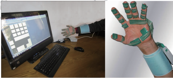
图 1 手指作用力测量实验平台 Fig. 1 Finger force measurement device
