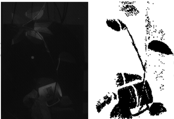
图 11 水下复杂视场的图像与点云 Fig. 11 Image and point cloud of underwater complex field
