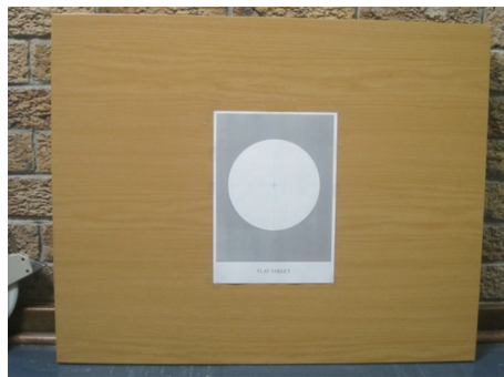
图 2 实验平板及平面标靶
