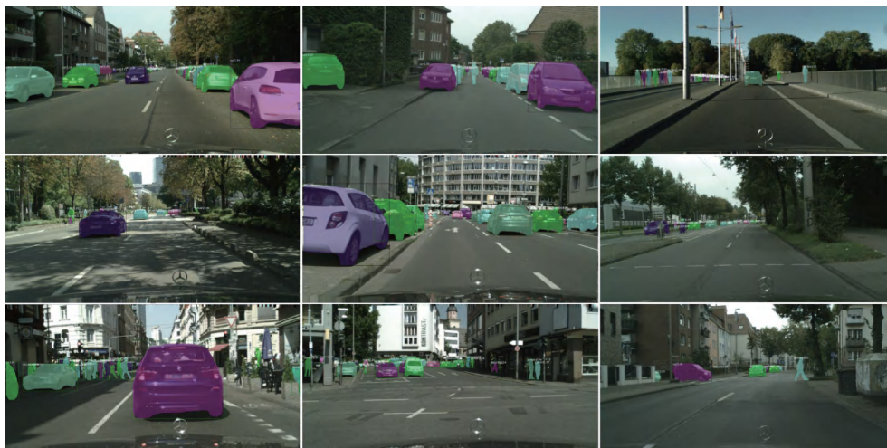
图7 在 Cityscapes 数据集上多尺度目标实例分割的可视化结果
