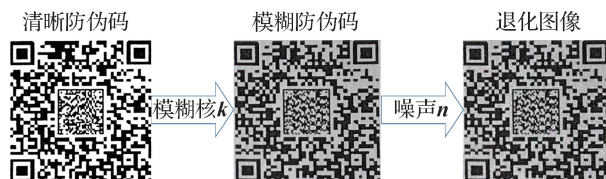
图3 防伪码图像的退化模型
