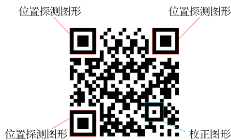
图1 QR码的位置探测图形与校正图形
