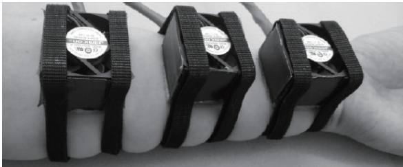
图 4 用户手上的热刺激阵列 Fig. 4 The thermal array display on user's arm
