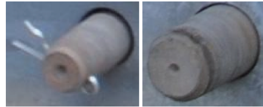
图11 带销螺母缺失螺栓和脱销螺母缺失螺栓
