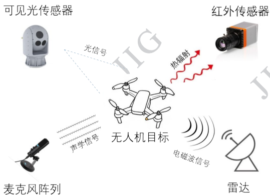
图6 多模态无人机目标检测 Fig. 6 Multimodal UAV object detection
