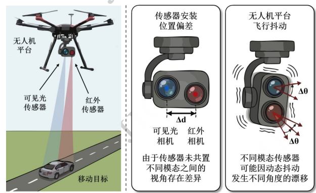
图1 无人机双载荷系统空间对准偏差的成因
