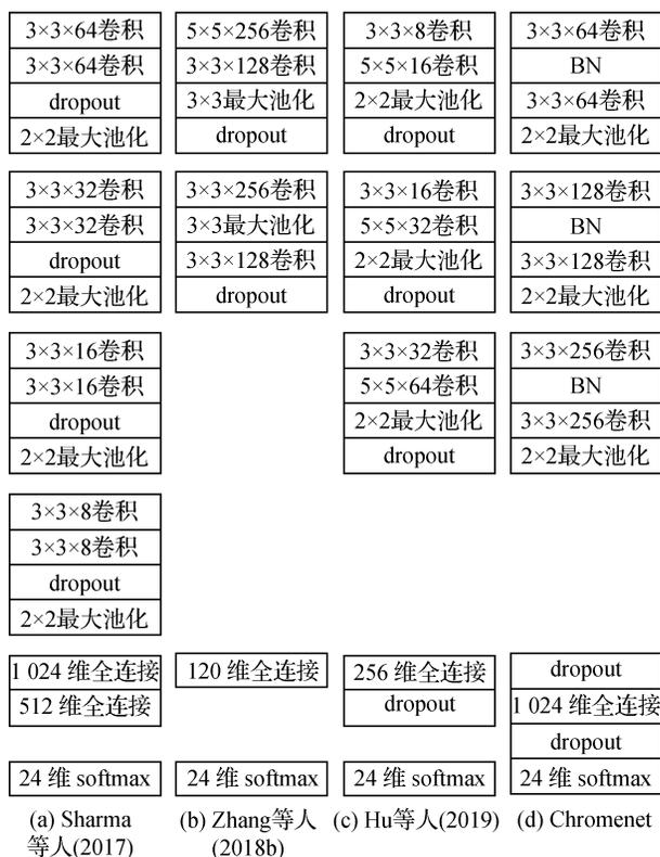
图5 基于简单CNN结构的分类网络架构
